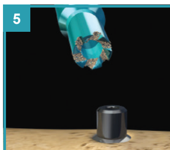
5: I detriti ossei sono visibili nelle scanalature del Bone Profiler.
